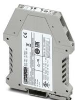
Relè elettronico con inversione del senso di marcia, per gestione dei motori DC, con LED e circuito di protezione, uscita: 10 ... 30 V DC/6 A con un tempo di commutazione di 80 ms
