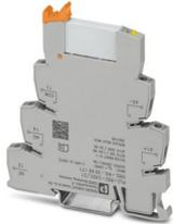
PLC-INTERFACE, composto da morsetto base PLC-BSC.../21 con connessione a vite e relè in miniatura a innesto con contatto di potenza, per montaggio su guida di supporto NS 35/7,5, 1 contatto di scambio, tensione di ingresso 24 V DC
