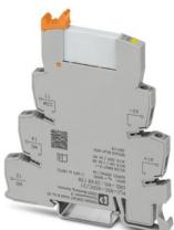
PLC-INTERFACE, composto da morsetto base PLC-BSC.../21 con connessione a vite e relè in miniatura a innesto con contatto di potenza, per montaggio su guida di supporto NS 35/7,5, 1 contatto di scambio, tensione di ingresso 60 V DC
