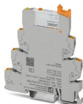
PLC-INTERFACE per funzioni di input, composta da morsetto base PLC-BPT.../SEN con connessione Push-in e relè in miniatura a innesto con contatto in oro multistrato e azionamento manuale, 1 contatto aperto a riposo, tensione di ingresso 230 V AC/220 V DC
