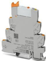
PLC-INTERFACE composta da morsetto base PLC-BPT.../21 con connessione Push-in e relè in miniatura a innesto con contatto in oro multistrato e azionamento manuale, 1 contatto di scambio, tensione di ingresso 230 V AC/220 V DC
