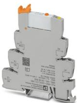
PLC-INTERFACE, composta da morsetto base PLC-BSC.../21 con connessione a vite e relè in miniatura a innesto con contatto di potenza e azionamento manuale, 1 contatto di scambio, tensione di ingresso 24 V AC/DC
