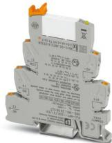
PLC-INTERFACE, composta da morsetto base montabile su guida da 6,2 mm con connessione Push-in e relè in miniatura a innesto con contatto di potenza 6 A, 1 contatto di scambio, tensione di ingresso 12 V DC. Omologata secondo ATEX/IECEx (zona 2) e zona Ex Class I, Div. 2.
