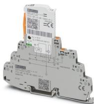
Protezione contro la sovratensione, composta da spina estraibile ed elemento base, con indicatore di stato integrato e sezionatore a coltello per tre fili del segnale con potenziale di riferimento comune. Per applicazioni HF e interfacce di telecomunicazione senza tensione di alimentazione, omologazione EX e per la zona 2. Utilizzabile in circuiti di sicurezza fino a SIL 3.
