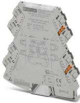
Separatore a 2 vie con loop di uscita alimentato a due canali con sistema di collegamento a innesto per la separazione galvanica di segnali analogici. Segnale di ingresso = segnale di uscita: 0(4) mA ... 20 mA. Connessione a vite.
