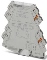
Separatore di alimentazione a 2 vie a un canale con alimentazione per loop di uscita e tecnologia di connessione a innesto per l'isolamento galvanico di segnali analogici. Segnale di ingresso = segnale di uscita: 0(4)mA...20mA. Tecnologia di connessione a vite.
