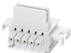
Connettore bus per guide DIN, colore: grigio chiaro, corrente nominale: 8 A (contatti paralleli), tensione di dimensionamento (III/2): 125 V, numero poli: 5, serie di prodotti: TBUS5-17,5.., passo: 3,81 mm, montaggio: Montaggio su guida DIN, bloccaggio: assente, tipo di fissaggio: assente, tipo di confezione: confezionato nel cartone, Articolo con contatti dorati, connettore bus per il collegamento a custodie per l'elettronica, 5 contatti paralleli
