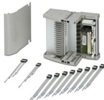
Termination Carrier universale per il collegamento di 16 isolatori galvanici MINI Analog a schede di ingresso/uscita digitali o analogiche, tramite connettori D-SUB, 37 poli (collegamento 1:1), con collegamento al multiplexer HART
