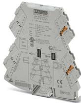
Isolatore galvanico a 3 vie con sistema di collegamento a innesto e commutazione calibrata del campo di misura per la separazione galvanica di segnali analogici unipolari e bipolari. Ingresso/uscita configurabili tramite DIP switch. Connessione a vite, configurazione standard.
