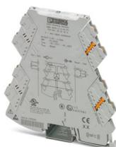
Isolatore galvanico a 3 vie con tecnologia di connessione a innesto per la separazione galvanica di segnali analogici. Segnale di ingresso: 0 V ... 10 V, segnale di uscita: 4 mA ... 20 mA, tecnologia di connessione Push-in
