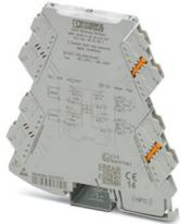
Separatore a 2 vie a due canali con alimentazione per loop di ingresso e tecnologia di connessione a innesto per l'isolamento galvanico di segnali analogici. Segnale di ingresso = segnale di uscita: 0(4) mA ... 20 mA. Tecnologia di connessione Push-in.
