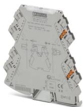
Separatore a 2 vie a un canale con alimentazione per loop di ingresso e tecnologia di connessione a innesto per l'isolamento galvanico di segnali analogici. Segnale di ingresso = segnale di uscita: 0(4)mA...20mA. Tecnologia di connessione a vite.
