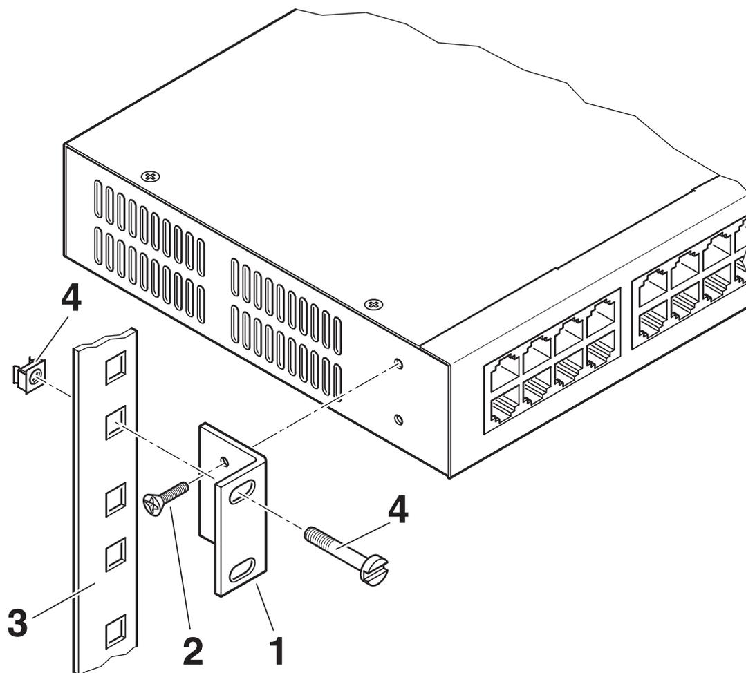
Fissare la staffa di bloccaggio sul lato dello switch servendosi delle viti in dotazioni (vedere la rappresentazione).
