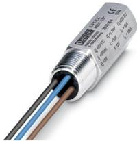
Protezione contro la sovratensione per un circuito del segnale libero da potenziale di terra nel modulo a vite con grado di protezione IP67 per teste di sensore, connessione da 1/2 pollice 14 NPT. Testata secondo i tipi di protezione per zone a potenziale rischio di esplosione Ex d / Ex tD / Ex ia IIC / Ex iaD. Adatto per l'utilizzo nel sistema di bus di campo secondo il concetto FISCO. Utilizzabile nei circuiti di sicurezza fino a SIL 3.
