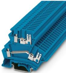
Morsetto passante, tensione nominale: 400 V, corrente nominale: 20 A, 1. e 2° piano, collegamento a sinistra, tipo di connessione: Connessione a vite, Sezione di dimensionamento: 4 mm<sup>2</sup>, sezione: 0,2 mm<sup>2</sup> - 4 mm<sup>2</sup>, tipo di connessione: Connessione Faston, montaggio: NS 35/7,5, NS 35/15, NS 32, colore: blu
