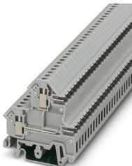
Morsetto passante a due piani, Corrente e tensione sono determinate dalla spina impiegata., 32 poli bloccato, tensione nominale: 250 V, corrente nominale: 10 A, tipo di connessione: Connessione a vite/a innesto, 1. e 2° piano, collegamento a sinistra, sezione: 0,2 mm<sup>2</sup> - 4 mm<sup>2</sup>, tipo di montaggio: NS 35/7,5, NS 35/15, NS 32, colore: grigio
