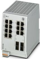
Managed Switch 2000 serie, 14 Porte RJ45 10/100 MBit/s, 2 SC-Multimode 100 MBit/s, grado di protezione: IP20, Temperatura ambiente (esercizio): -40 °C ... 70 °C, Intervallo di tensione di alimentazione: 12 V DC ... 57 V DC, PROFINET Conformance-Class B, Campo di temperatura esteso, Processo di sviluppo certificato secondo la norma IEC 62443-4-1, Compatibile con la norma IEC 62443-4-2
