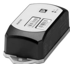
WLAN Access Point, client con due antenne interne (MIMO) per montaggio monoforo, IP66/68, WLAN 802.11 a, b, g, n, frequenza: 2,4 GHz, 5 GHz (incl. canali DFS), collegamenti COMBICON: 9 ... 32 V DC, RJ45 per LAN, Web, http/https, CLI
