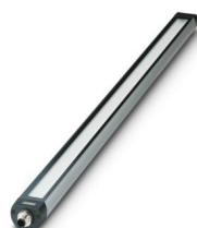
Illuminazione macchine a LED, 24 V DC, angolo di diffusione (verticale/orizzontale): 85 °/95 °, lunghezza: 715 mm, dimensioni: 40 mm, grado di protezione: IP67, orientabile, Resistente a lubrificanti e refrigeranti
