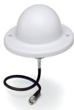
Antenna omnidirezionale con protezione da atti vandalici per montaggio su quadro elettrico, banda di frequenza: 2,4 GHz, guadagno: 3 dBi, grado di protezione: IP55, resistenza agli urti: IK08, connessione: RSMA (maschio), cavo di connessione di 1,5 m incluso
