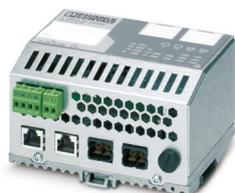
Ethernet Switch, due porte tipo RJ45 e due porte tipo POF SC-RJ per PROFINET RT/IRT, innestabile su guide di montaggio
