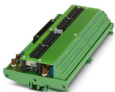
Modulo relè di uscita a 32 canali (1 contatto in chiusura, opzionalmente legato al potenziale) con collegamento a molla, fusibile (2 AT) e sistema di connessione a 50 poli. Indicato per schede Yokogawa ADV 551 e ADV 561.
