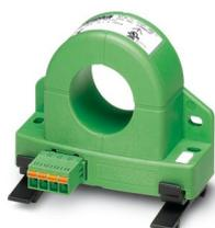
Convertitori di corrente universali per la misurazione di correnti continue, alternate e distorte, corrente d'ingresso 0 ... 200 A, uscita 4 ... 20 mA
