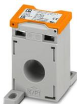
Trasformatore di corrente circolare, corrente primaria 150 A AC; corrente secondaria 5 A AC; classe di precisione 1; potenza nominale 5 VA
