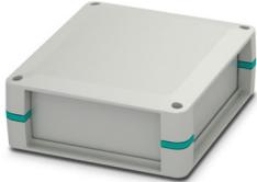
Custodia completa per circuiti stampati, posizionabile in modo flessibile; contiene i semigusci della custodia, pareti laterali chiuse, calotta a incollaggio per fissaggio schede, viti per custodia e fissaggio scheda; colore custodia grigio chiaro con inserti angolari blu turchese
