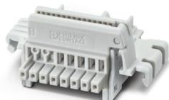
Connettore bus per guide DIN, colore: grigio chiaro, corrente nominale: 6 A, 4 A (contatti paralleli) (contatti seriali), tensione di dimensionamento (III/2): 32 V, numero poli: 8, serie di prodotti: TBUS8-20..., passo: 2,54 mm, montaggio: Montaggio su guida DIN, bloccaggio: assente, tipo di fissaggio: assente, tipo di confezione: confezionato nel cartone, Articolo con contatti dorati, connettore bus per il collegamento con custodie per l'elettronica, 7 contatti paralleli/1 contatto seriale
