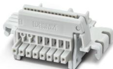
Connettore bus per guide DIN, colore: grigio chiaro, corrente nominale: 6 A, 4 A (contatti paralleli) (contatti seriali), tensione di dimensionamento (III/2): 32 V, numero poli: 8, serie di prodotti: TBUS8-20.., passo: 2,54 mm, montaggio: Montaggio su guida DIN, bloccaggio: assente, tipo di fissaggio: assente, tipo di confezione: confezionato nel cartone, Articolo con contatti dorati, connettore bus per il collegamento con custodie per l'elettronica, 6 contatti paralleli/2 contatti seriali
