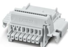
Connettore bus per guide DIN, colore: grigio chiaro, corrente nominale: 6 A (contatti paralleli), tensione di dimensionamento (III/2): 32 V, numero poli: 8, serie di prodotti: TBUS8-25.., passo: 2,54 mm, montaggio: Montaggio su guida DIN, bloccaggio: assente, tipo di fissaggio: assente, tipo di confezione: confezionato nel cartone, Articolo con contatti dorati, connettore bus per il collegamento con custodie per l'elettronica, 8 contatti paralleli
