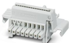
Connettore bus per guide DIN, colore: grigio chiaro, corrente nominale: 6 A (contatti paralleli), tensione di dimensionamento (III/2): 32 V, numero poli: 8, serie di prodotti: TBUS8-18,8..., passo: 2,54 mm, montaggio: Montaggio su guida DIN, bloccaggio: assente, tipo di fissaggio: assente, tipo di confezione: confezionato nel cartone, Articolo con contatti dorati, connettore bus per il collegamento con custodie per l'elettronica, 8 contatti paralleli
