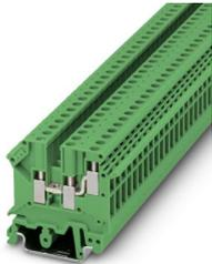
Morsetto a 1 piano con attacco doppio su un lato, sezione: 0,2 - 4 mm<sup>2</sup>, AWG: 24- 12, spessore: 6,2 mm, colore: verde
