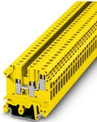
Morsetto a 1 piano con attacco doppio su un lato, sezione: 0,2 - 4 mm<sup>2</sup>, AWG: 24- 12, spessore: 6,2 mm, colore: giallo
