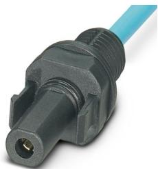
Connettore per apparecchi anteriore, Serie di prodotti: SUNCLIX, colore: nero, sezione del conduttore min.: 4 mm<sup>2</sup>, corrente nominale: 35 A, Tipo di connessione: A crimpare, lunghezza cavo: 130
