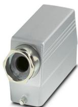
Custodia mobile, per bloccaggio trasversale, altezza 76 mm, con attacco a vite, 1x Pg21 uscita cavo laterale
