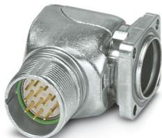
M23, Connnettore per apparecchi anteriore, serie: CA, angolato, orientabile, schermato: sì, per bloccaggio standard e SPEEDCON, Numero di poli: 12, Senso di rotazione: Invertito, tipo di connessione del contatto: Spina, Connessione a crimpire, O-ring assiale, codifica: N
