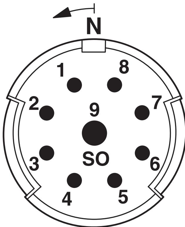
Numerazione camera contatti (visualizzazione lato innesto) connettore maschio invertito
