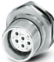
M23, Connnettore per apparecchi posteriore, serie: CA, diritto, schermato: sì, per bloccaggio standard e SPEEDCON, Numero di poli: 6, Senso di rotazione: standard, tipo di connessione del contatto: Femmina, Connessione a crimpire, Guarnizione assiale, codifica: N. Questo prodotto è in fase di dismissione. Questo prodotto non può più essere preso in considerazione per nuovi progetti. Per eventuali alternative, contattare il proprio rappresentante commerciale.
