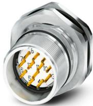
M23, Connettore per apparecchi posteriore, serie: CA, diritto, schermato: sì, per bloccaggio standard e SPEEDCON, Numero di poli: 12, Senso di rotazione: standard, tipo di connessione del contatto: Spina, Connessione a crimpare, Guarnizione assiale, codifica: N, questo articolo dovrebbe essere privo di piombo dal primo trimestre 2027 secondo la RoHS II senza l'eccezione 6c (Pb < 0,1 %), un'alternativa priva di piombo è disponibile in anticipo su richiesta
