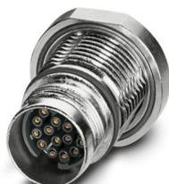
Connettore per apparecchi posteriore, diritto, per bloccaggio standard e SPEEDCON, M17, numero poli: 17, tipo di connessione del contatto: Femmina, O-ring assiale, schermato: sì, numero poli: 17, tipo di connessione: Connessione a crimpare, serie: ST
