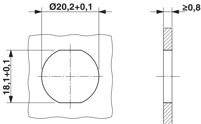
Dimensioni di installazione: montaggio con protezione antitorsione e dado
