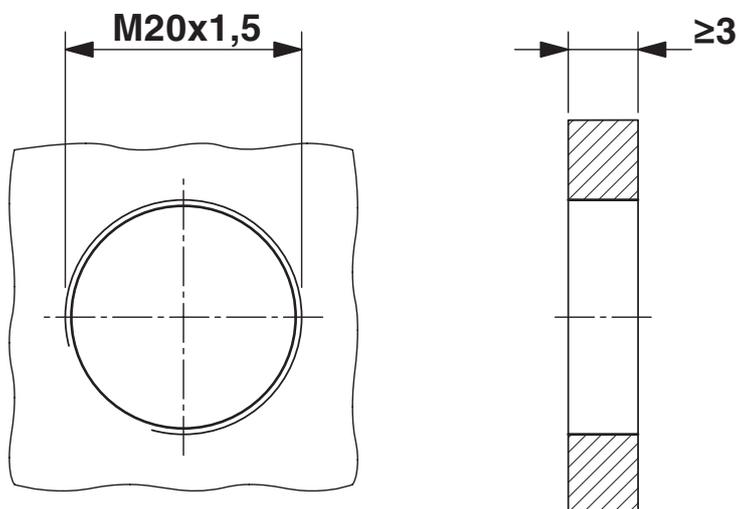
Dimensioni di installazione: montaggio con filettatura
