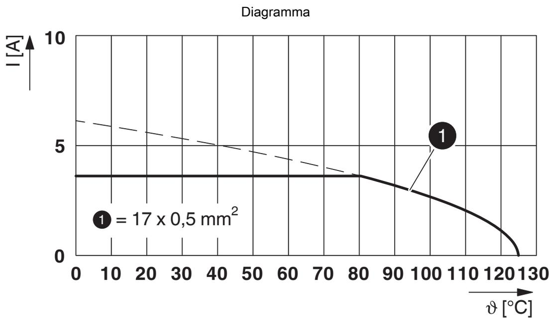
$I$  = intensità di corrente,  $\vartheta$  = temperatura ambiente, 17x 3,6 A
