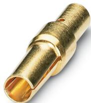
Contatto a crimpare, Femmina, tornito, diametro contatti: 1 mm, sezione di connessione: 0,08 mm<sup>2</sup> ... 0,22 mm<sup>2</sup>, materiale contatti: CuZn, Prodotto alternativo secondo RoHS II senza eccezione 6c (Pb < 0,1 %) cod. art.: 1241093
