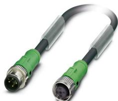
Cavo sensore/attuatore, 4-poli, PUR, grigio-nero RAL 7021, Maschio diritto M12 SPEEDCON, codifica: A, su Connettore femmina diritto M12 SPEEDCON, codifica: A, lunghezza cavo: 15 m
