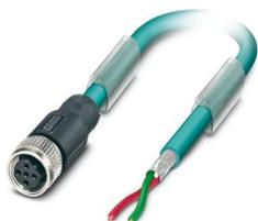
Cavo di sistema bus, PROFIBUS, 2-poli, PUR/PVC, blu, schermata, estremità conduttore libera, su Connettore femmina diritto M12, codifica: B, lunghezza cavo: 10 m
