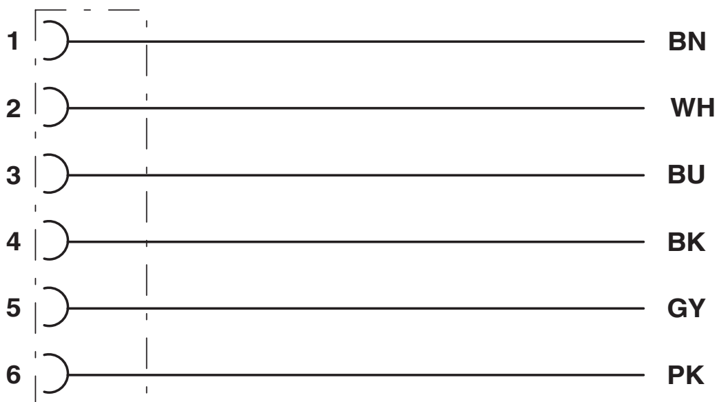
Equipaggiamento dei contatti del connettore femmina M8
