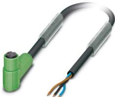
Cavo sensore/attuatore, 3-poli, PUR senza alogenati, grigio-nero RAL 7021, estremità conduttore libera, su Connettore femmina angolato M8 Snap-in, codifica: A, lunghezza cavo: 5 m
