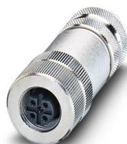
Connettore dati, PROFIBUS, INTERBUS, 5-poli, schermata, Femmina diritto M12, codifica: B, Connessione a vite, materiale zigrinato: Pressogetto di zinco, nichelato, connessione a vite per cavo Pg9, diametro esterno conduttore 6,5 mm ... 8,5 mm
