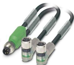
Cavo sensore/attuatore, 3-poli, PUR senza alogenati, grigio-nero RAL 7021, Maschio diritto M8, codifica: A, su Connettore femmina angolato M8, codifica: A, con 2 LED e Connettore femmina angolato M8, codifica: A, con 2 LED, lunghezza cavo: 1,5 m
