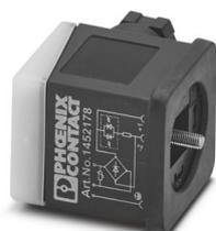
Connettore per valvole, Universale, 5-poli, Connettore per valvole AD (pressostato), Connessione a vite, connessione a vite per cavo M20 x 1,5, diametro esterno conduttore 6 mm .. 8 mm
