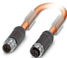
Cavo di sistema bus, FOUNDATION Fieldbus (31,25 kBit/s), 3-poli, PVC, arancio RAL 2003, schermata, Maschio diritto M12, codifica: A, su Connettore femmina diritto M12, codifica: A, lunghezza cavo: 10 m
